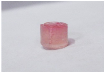
Клеточно - инженерная конструкция (КИК), напечатанная на 3D-принтере (d = 4 мм. h = 5 мм), живое фото
