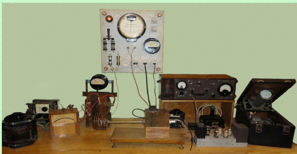
Установка , на которой Е.К.Завойский впервые наблюдал явление ЭПР
